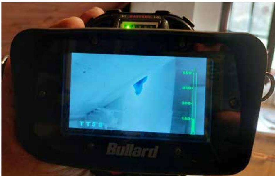
**Blick durch die Wärmebildkamera der Feuerwehr. Klar zu erkennen der heiße, dunkel eingefärbte Teil in der Bildmitte und die Temperaturskala rechts.**
